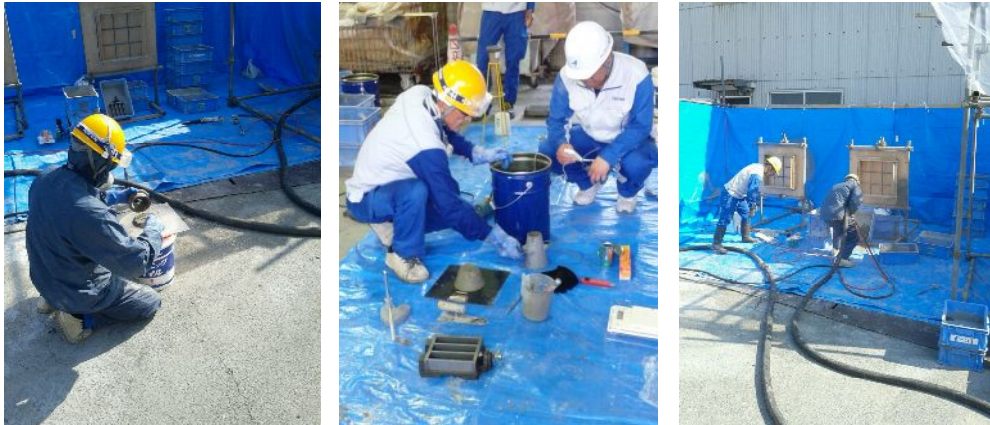
「クロルフィックスショット」現場品質管理試験、試験体採取状況
